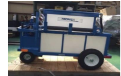
LAVATORY UNIT 汚物汲取車
