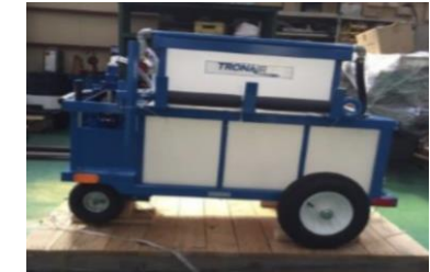
LAVATORY UNIT 汚物汲取車
