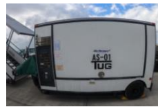
ASU (Air Starter Unit) エンジン起動車
