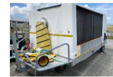
ACU (Air Conditioning Unit) エアコン車
